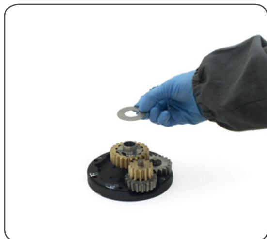
9. Remove the washer n°11
