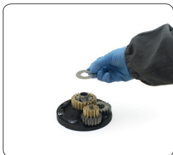
9. Remove the washer n°11
