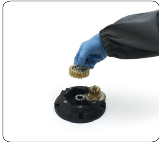
11. Remove the gear n°9 and remove the pawls n°6.
