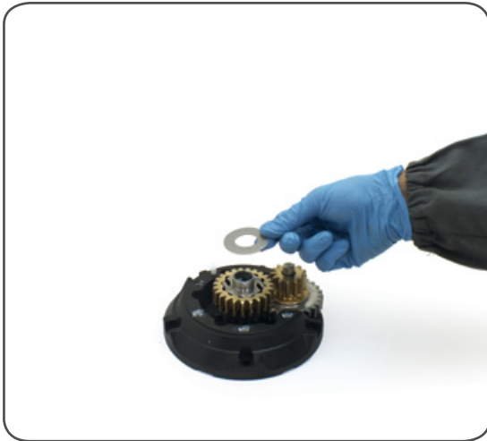
10. Remove the washer n°12
