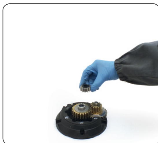
9. Remove the gear n°14
